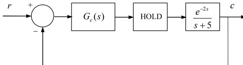
dove il controllore  $G_c(s)$  è costituito da una rete ritardatrice:  $G_c(s) = K \frac{1 + \alpha\tau s}{1 + \tau s}$ . Si voglia progettare un regolatore digitale mediante l'uso delle tecniche di discretizzazione dei regolatori continui. A tal fine si ricavino i coefficienti del regolatore continuo  $G_c(s)$  capace di garantire
